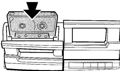
Insérez une cassette avec le côté exposé du ruban magnétique en bas. Appuyez sur le porte-cassette pour le fermer.
